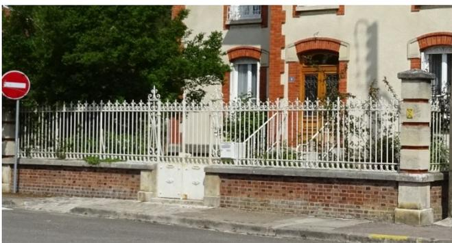
*Photo (2) : Clôture composée d'un mur bahut en pierre de taille et en brique, d'un pilier en pierre de taille ainsi que d'une grille et d'un portail en ferronnerie - 2, rue du Vieux marché.*
