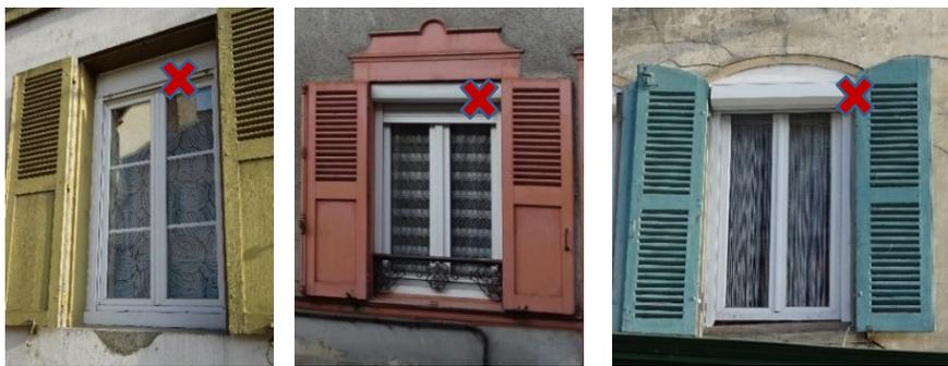
Exemples de volets roulants en PVC avec coffre intégré ou coffre débordant interdits
